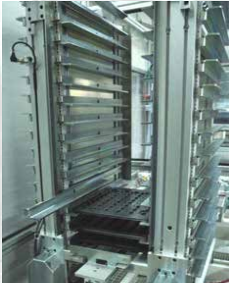
Chenilles verticales recevant les réglettes support de plateaux thermoformés
