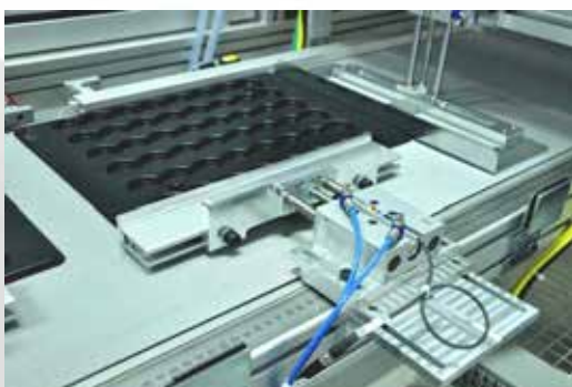
Chenilles verticales recevant les réglettes support de plateaux thermoformés
